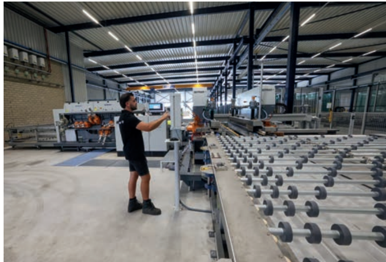
▲ Walter Truijen aan het werk bij de BENTELER-verwerkingslijn. Met de tec Driller HD Pro kan Buys Glas flexibel boren, frezen en zelfs waterstraalsnijden in één geïntegreerd systeem.
