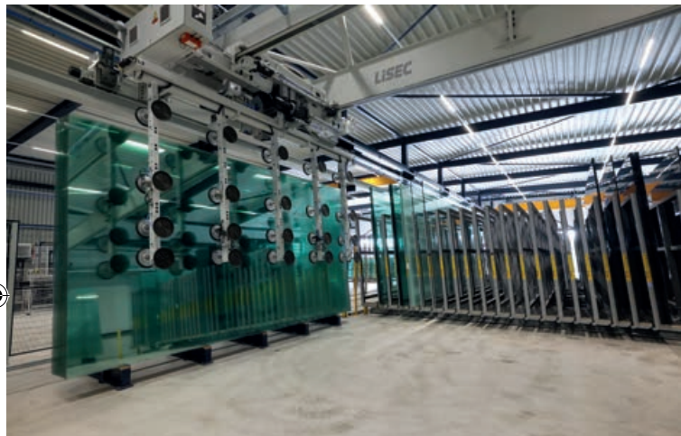
▲ Close-up van het LiSEC-opslagsysteem voor jumboformaten, dat glasplaten veilig en efficiënt naar de snijlijnen transporteert.
