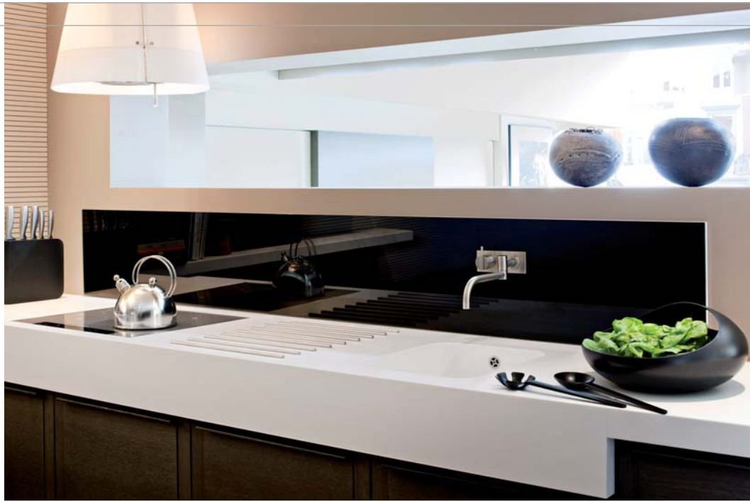
Lacobel T kan temperaturen tot 200 graden verdragen, waardoor ook toepassingen achter kookforuizen mogelijk worden.
