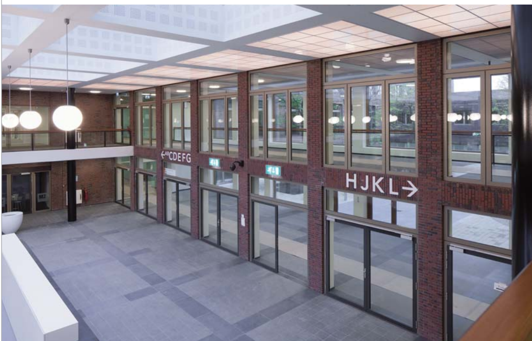
De centrale toegangshal is rondom ingevuld met brandwerende puien.
