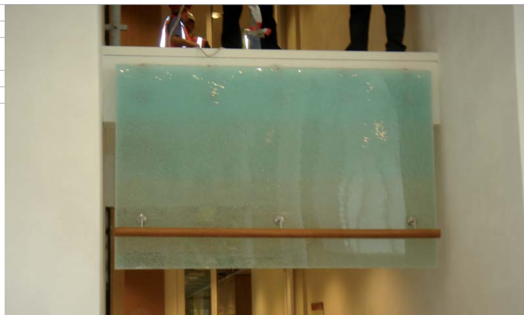
Omdat ze ons met de neus op de feiten drukken, herhalen we deze foto's nog eens, ook al zijn helaas wat onscherp. Het gaat om een glazen balustrade met een glaspaneel vóór en ná de slingertest. Door te korte busjes in de metalen verbindingen onderaan, klapt de hele balustrade om tijdens de test.
