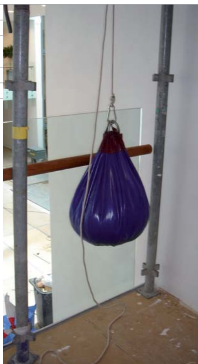
Omdat ze ons met de neus op de feiten drukken, herhalen we deze foto's nog eens, ook al zijn helaas wat onscherp. Het gaat om een glazen balustrade met een glaspaneel vóór en ná de slingertest. Door te korte busjes in de metalen verbindingen onderaan, klapt de hele balustrade om tijdens de test.
