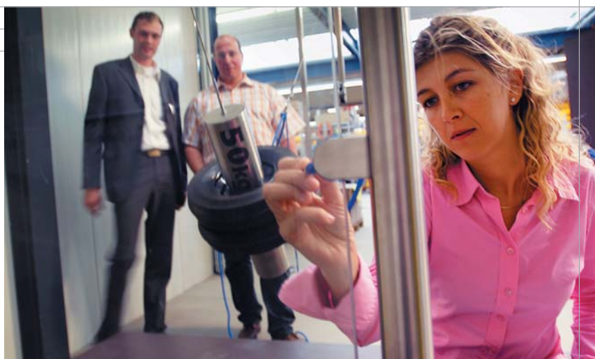
Test met het kruiwagenwiel. Q-railing test haar producten ook in toegepaste situaties.
